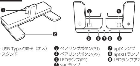
※⑥⑦⑧：接続されている機器のコードックが点灯して表示されます。
